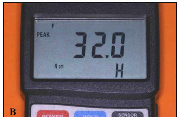
Figura 4.8A. Medidor de torque utilizado; B. Confirmação do torque aplicado ao parafuso protético.
