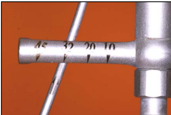
Figura 4.7. Catraca torquímetro protética sendo utilizada para chegar ao torque de 32 Ncm.
