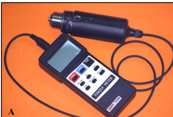
Figura 4.8A. Medidor de torque utilizado; B. Confirmação do torque aplicado ao parafuso protético.
